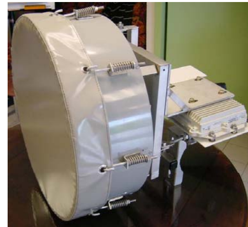
Protection par blindage cage de Faraday et matériaux absorbants autour d'une antenne Cassegrain Wirake
